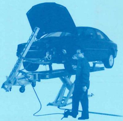
フレーム修正機は、自動車のフレームや車体構造に損傷がある場合に使用される専門的な修理装置です。交通事故や衝突によって歪んだ車のフレームを元の形状に戻すために設計されています。この機械は、精密な計測機器と強力な引張力を使用して、フレームや車体の歪みを修正します。
